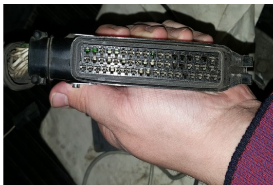
Рис. 9. Подсоединение электронного прибора ДБД-4 через штатный разъем электронного блока управления
