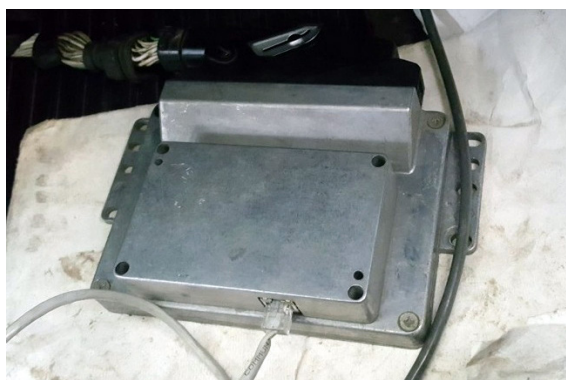
Рис. 9. Подсоединение электронного прибора ДБД-4 через штатный разъем электронного блока управления
