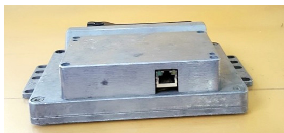
Рис. 8. Прибор для формирования нагрузки на ДВС ДБД-4
