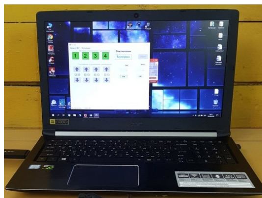
Рис. 10. Подсоединение электронного прибора ДБД-4 при помощи LAN-кабеля к персональному компьютеру Acer ASPIRE A715-71G-56BD и загрузка программы Mikas 5.1 на персональном компьютере
