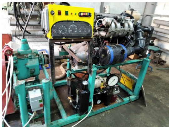
Рис. 7. Стенд с возможностью обеспечения режимов нагружения приборными методами и электродвигателем в его конструкции
