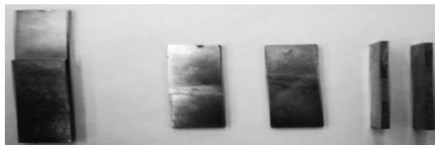
Рис. 2. Общий вид образцов для определения предела прочности при сдвиге
