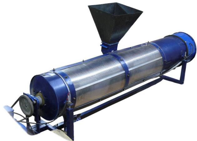
Рис. 2. Лабораторная установка воздушно-шнекового сепаратора
