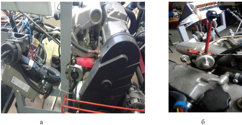
Рис. 2. Приспособления для проведения экспериментальных исследований: а – индивидуальные трубки со змеевиками; б – фиксатор дроссельной заслонки
