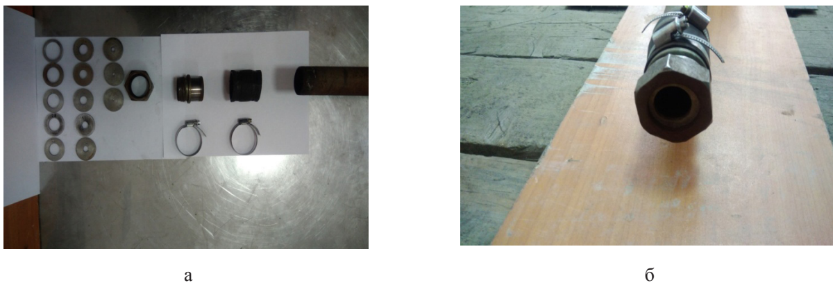
Рис. 3. Приспособления для имитации неисправностей: а – комплект шайб для создания сопротивления на выпуске; б – наконечник выхлопной трубы
