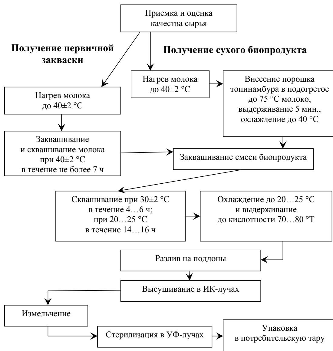
Рис. 3. Технологическая схема производства функционального сухого биопродукта «Наринар», обогащенного топинамбуром
