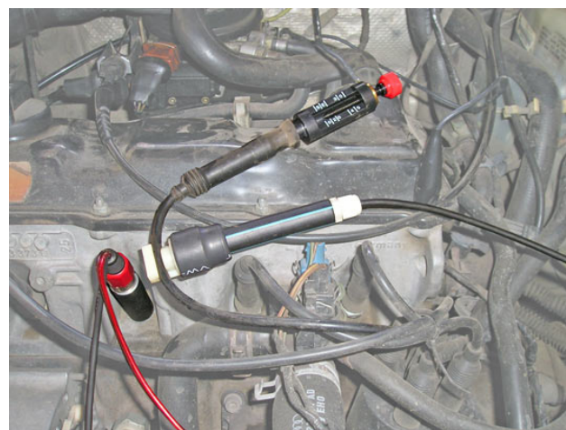
Рис. 1. Подсоединение датчиков Pх и Dх цифрового осциллографа USB Autoscope III к элементам двигателя
