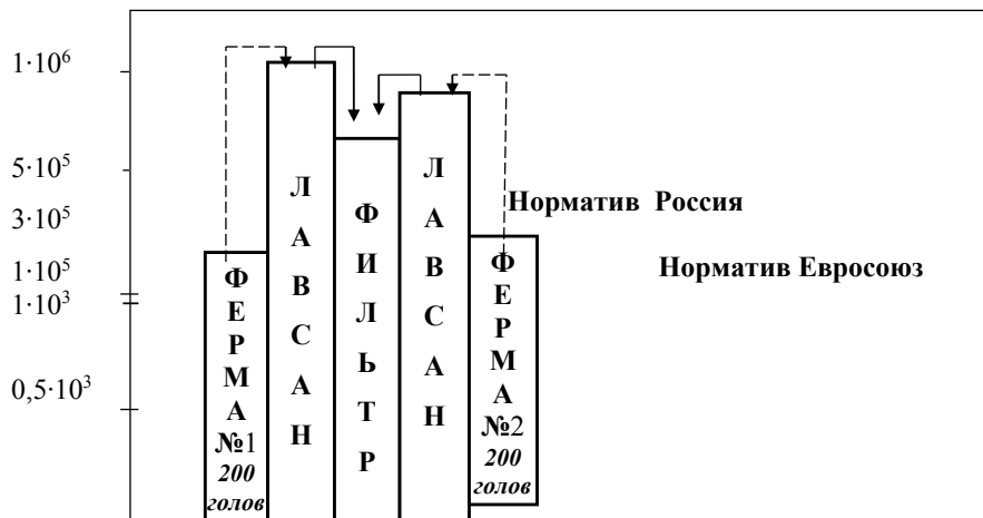
Рис. 2. Влияние механических фильтров на содержание мезофильных аэробных и факультативно-анаэробных микроорганизмов (КМАиФАМ) в молоке
