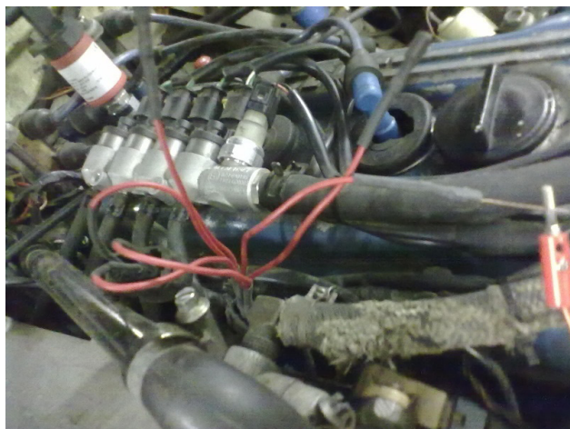
Рис. 1. Датчик давления, вкрученный в свечное отверстие цилиндра двигателя ЗМЗ-4062
