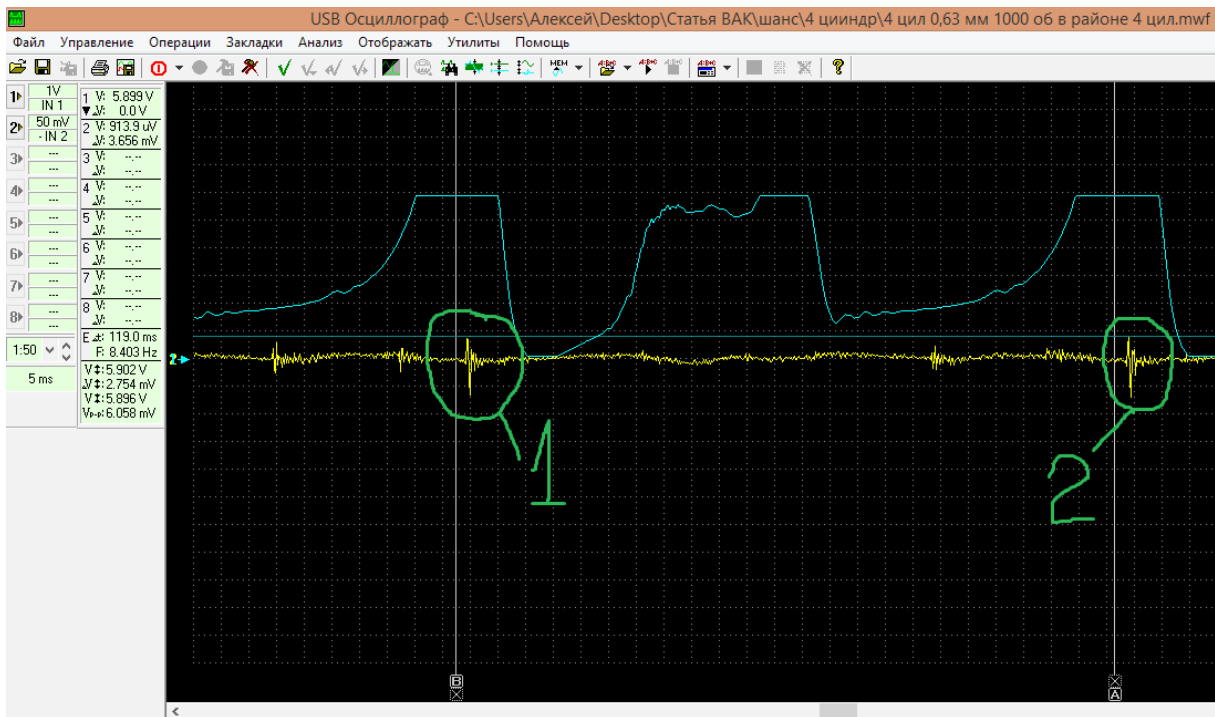
1-й канал – изменение давления в цилиндре, снятое датчиком давления; 2-й канал – вибросигнал, снятый акселерометром
