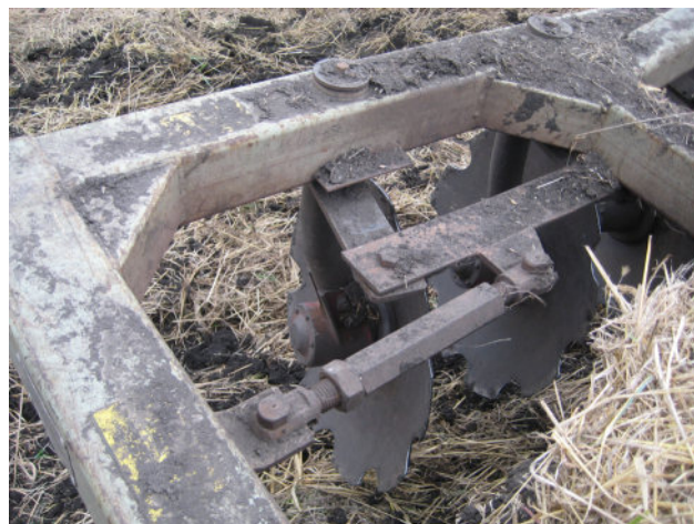
Рис. 2. Механизм регулировки угла атаки дисков
