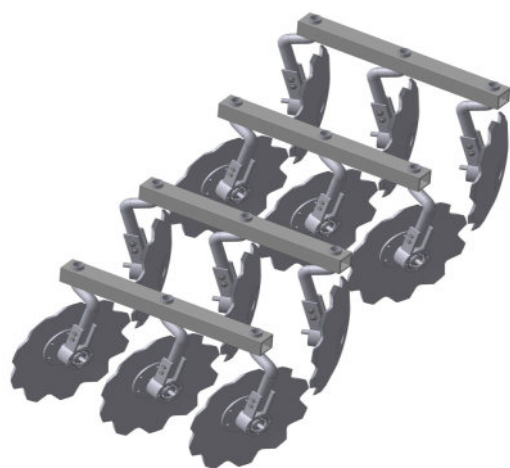
Рис. 1. Схема расположения рабочих органов дискатора
