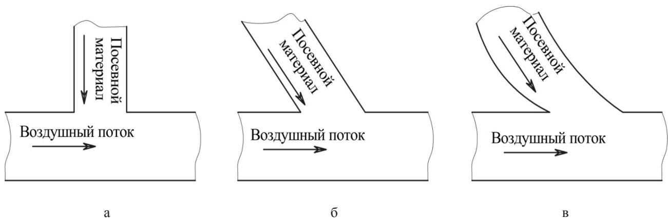
Рис. 2. Варианты конструктивного исполнения загрузочного устройства пневматической высевальной системы: а – загрузочный патрубок и пневмопровод расположены под прямым углом друг к другу; б – загрузочный патрубок и пневмопровод расположены под острым углом друг к другу; в – загрузочный патрубок с криволинейной поверхностью и пневмопровод расположены под острым углом друг к другу
