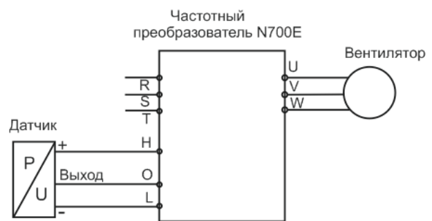
Рис. 2. Электрическая схема системы регулирования скорости теплоносителя
