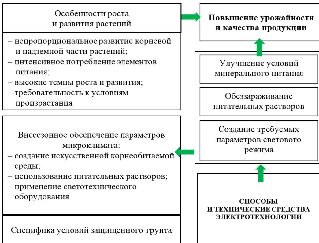
Рис. 1. Способы и технические средства электротехнологии в растениеводстве защищенного грунта
