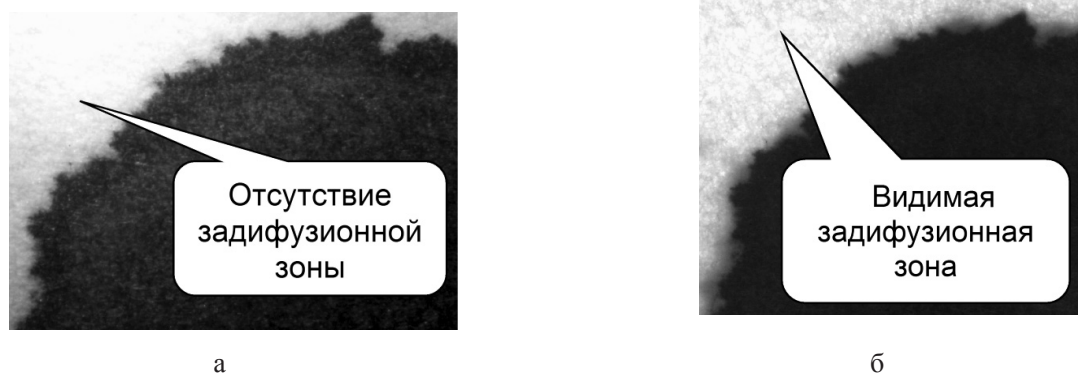
Рис. 8. Сравнительный вид хроматограмм: а – вид хроматограммы после выдержки на тигле; б – вид хроматограммы после выдержки при комнатной температуре в течение 2 часов
