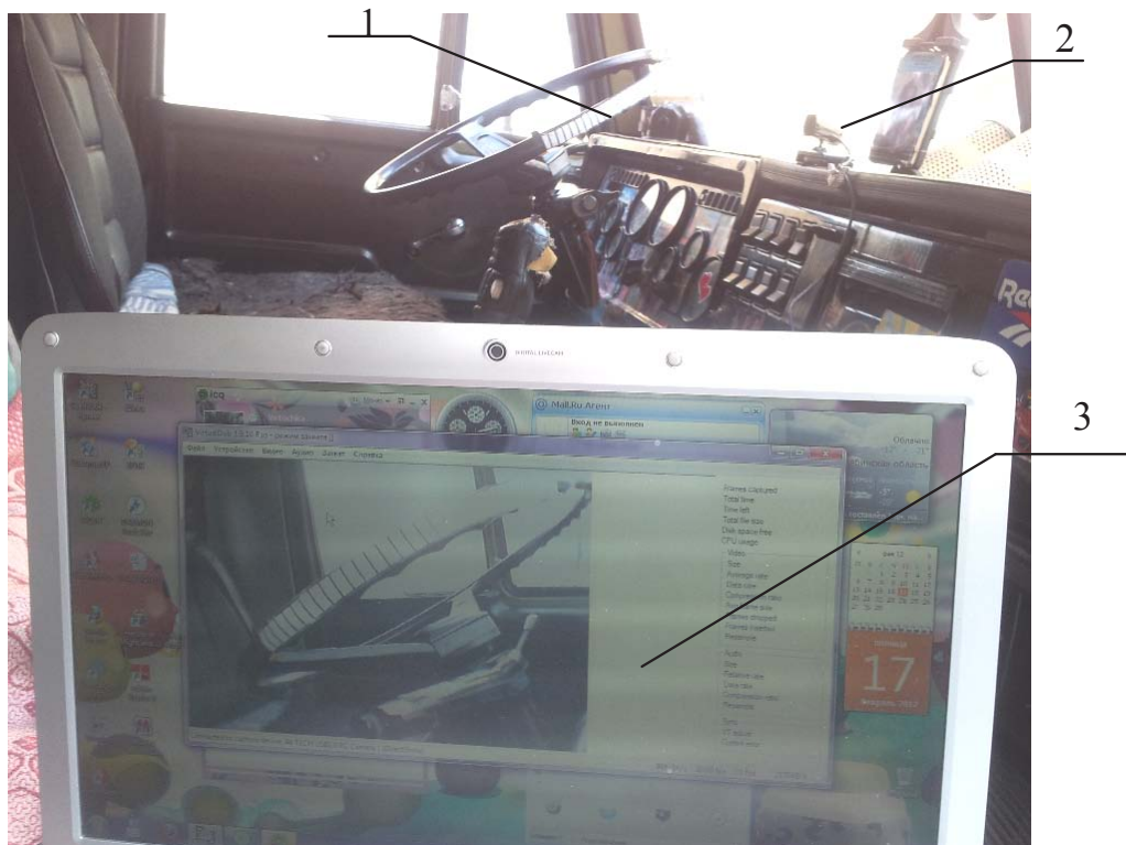
1 – шкала с делениями на руле автомобиля; 2 – видеокамера; 3 – записывающее устройство
