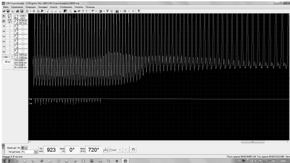
1 – сигнал давления в первом цилиндре ДВС; 2 – импульс системы зажигания
