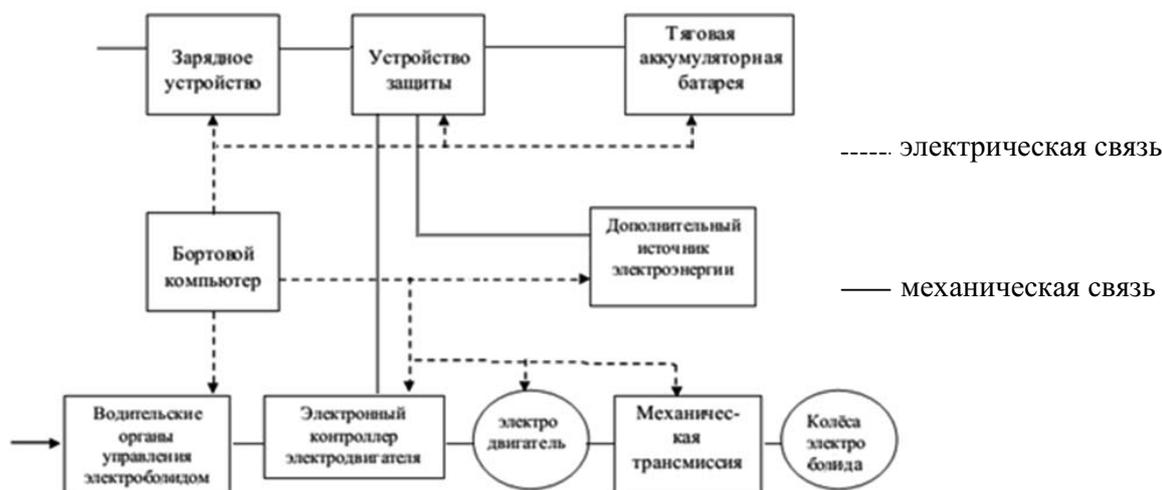
Рис. 2. Блок-схема электробоида
