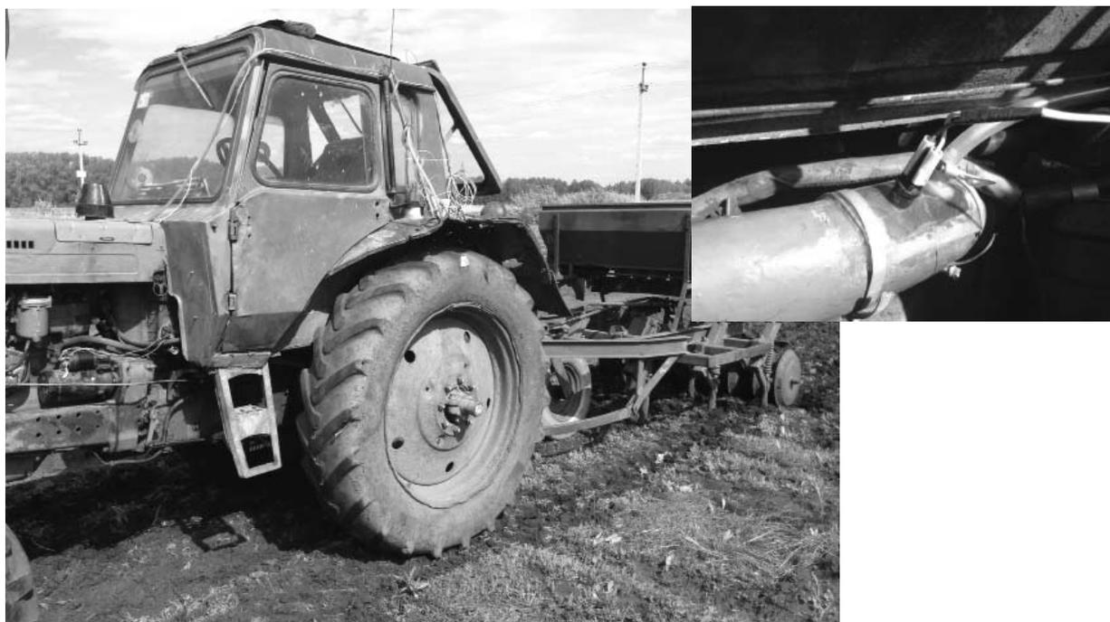
Рис. 1. Трактор МТЗ-82 с двигателем, снабженным водным (водоспиртовым) инжектором, в агрегате со стерневой зерновой сеялкой СЗС-2,1
