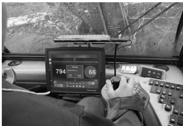
Рис. 5. Комбинация приборов Харвестера John Deere 903KH
